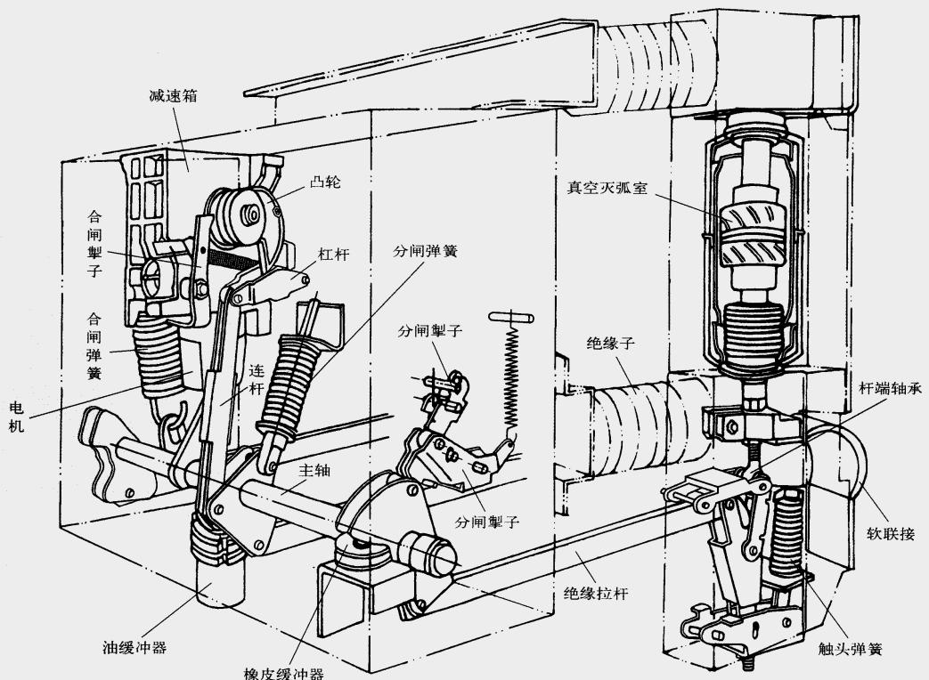
图 4. 操动机构动作原理图
