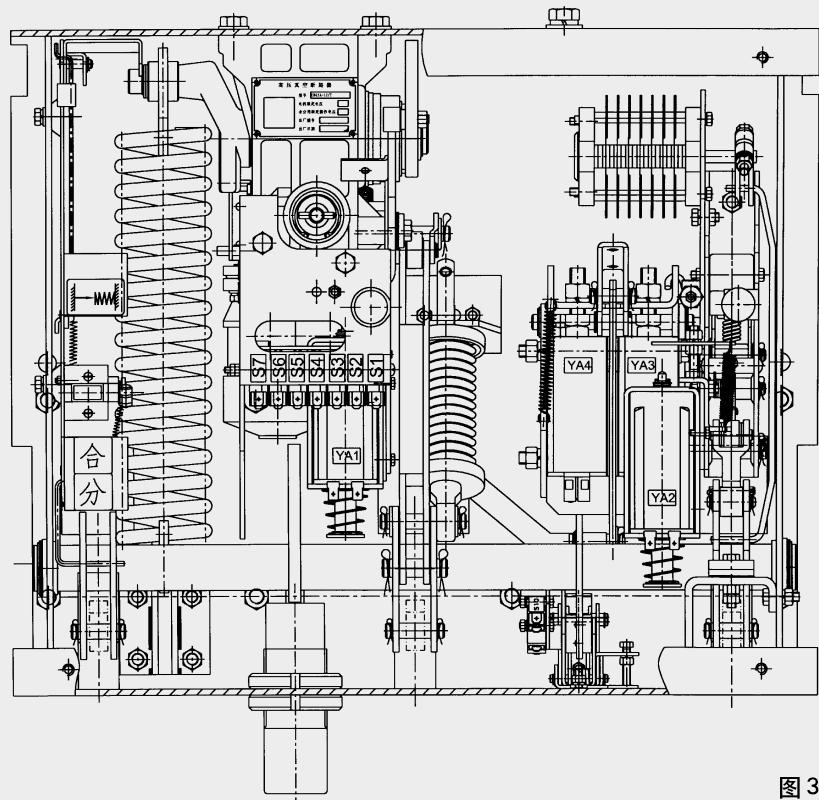
图 3. 操动机构动作原理图
